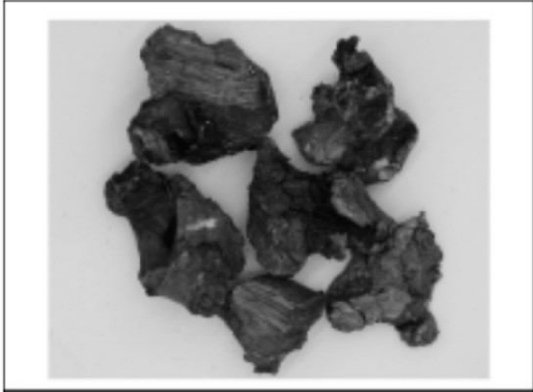
a) 还蒸工序氧化的海绵钛块
