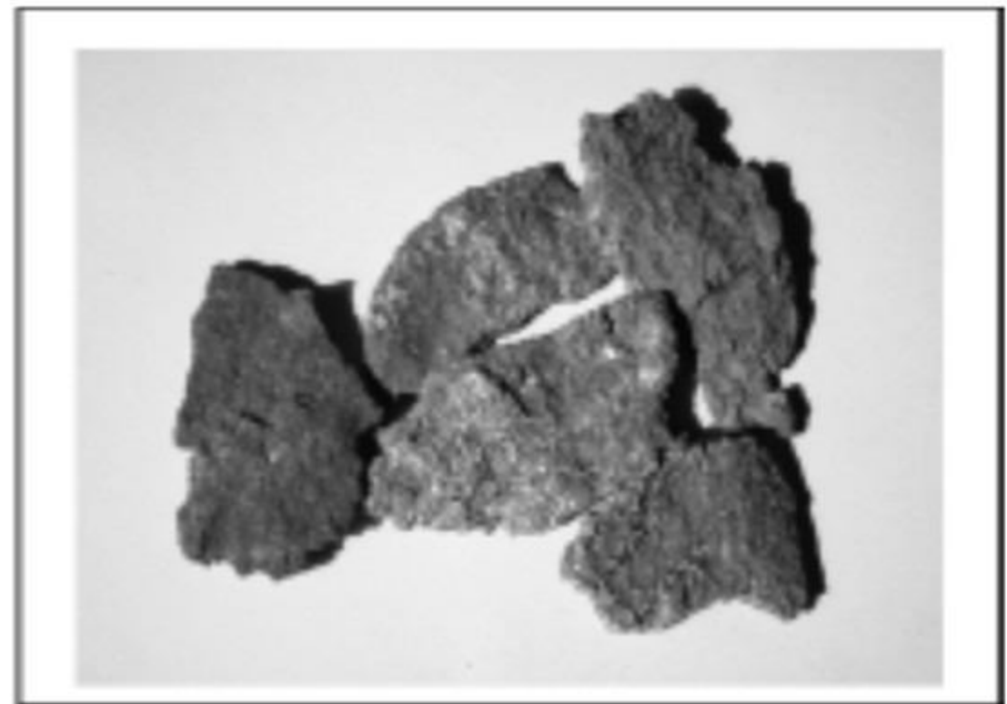
b) 破碎工序氧化的海绵钛块
